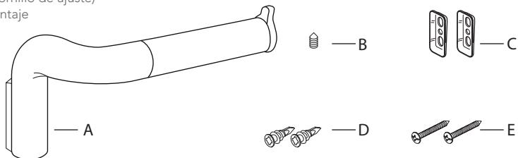
1. Destornillar la placa de montaje (C) y herramientas ubicados en la parte trasera del accesorio(A)
