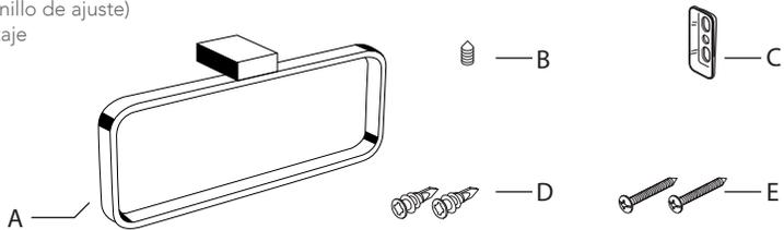
1. Destornillar la placa de montaje (C) y herrajes ubicados en la parte trasera del accesorio(A)
