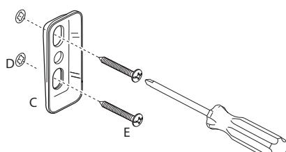
4. Una vez ajustado los tornillos (E), coloque el accesorio (A) sobre la placa de montaje (C) y apriete el prisionero (B).
