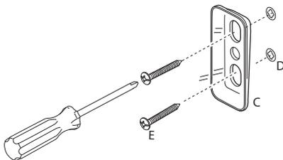
4. Una vez ajustado los tornillos (E), coloque el accesorio (A) sobre la placa de montaje (C) y apriete el prisionero (B).
