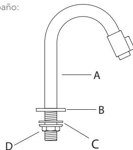
1. Separar el anillo de goma (C) y la Tuerca de Montaje (D) de la base de la grifería. Mantenga el Anillo de Ajuste de la Base (B) y el Anillo de Goma (C) en la base de la grifería.
